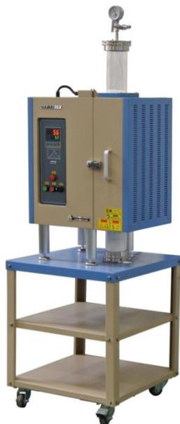
OTF-1200X-VT 是一款通过 CE 认证的可开盖垂直气氛管式炉，能够实现在真空或气氛保护条件下对样品快速升降温，30 段可编程温度控制器，控温精度 $\pm 1^{\circ}\text{C}$ 。炉体垂直安装在可移动的支架上方便炉管的取放。
