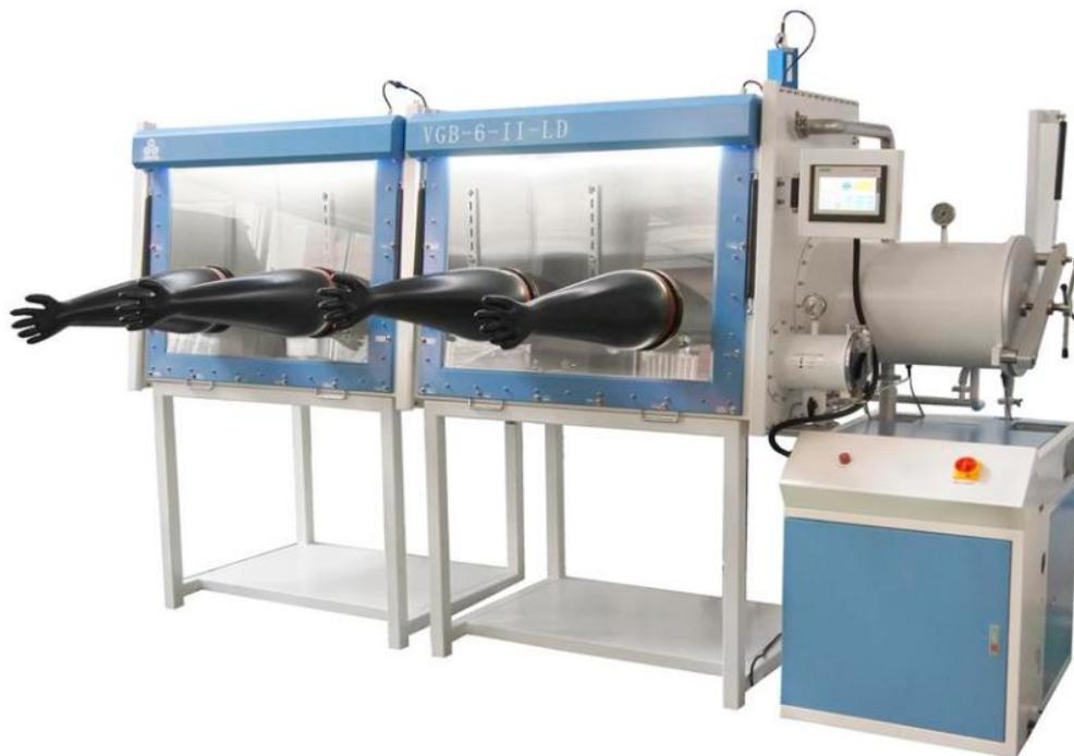
VGB-6-II 是一款双连体不锈钢手套箱，仪器中的净化系统是由德国 BASF 公司提供的抗氧化材料制作，而除水剂是由美国 UOP 公司提供，使得手套箱内的水氧含量可以达到 1ppm，所以可以为许多实验创造一个无水无氧的洁净环境。同时仪器本身带有压力控制，纯度控制，气体自动循环再生控制和数据读取等功能。手套箱设计为开启式，客户操作会更加容易和方便。VGB-6-II 被广泛的用于制备纳米材料、锂离子电池、催化剂和金属有机物等。
