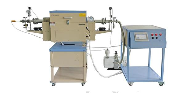
OTF-1200X-4-R-II 是一款通过 CE 认证的双温区可旋转管式炉,炉体与控制系统分开设计,控制系统上带有通讯接口,可以远程操控。此款设备专门针对于材料的混合烧结,特别适用于锂离子电池材料的混合烧结,如 LiFePO4, LiMNiO4 等。(图片仅供参考,请以实物为准)
