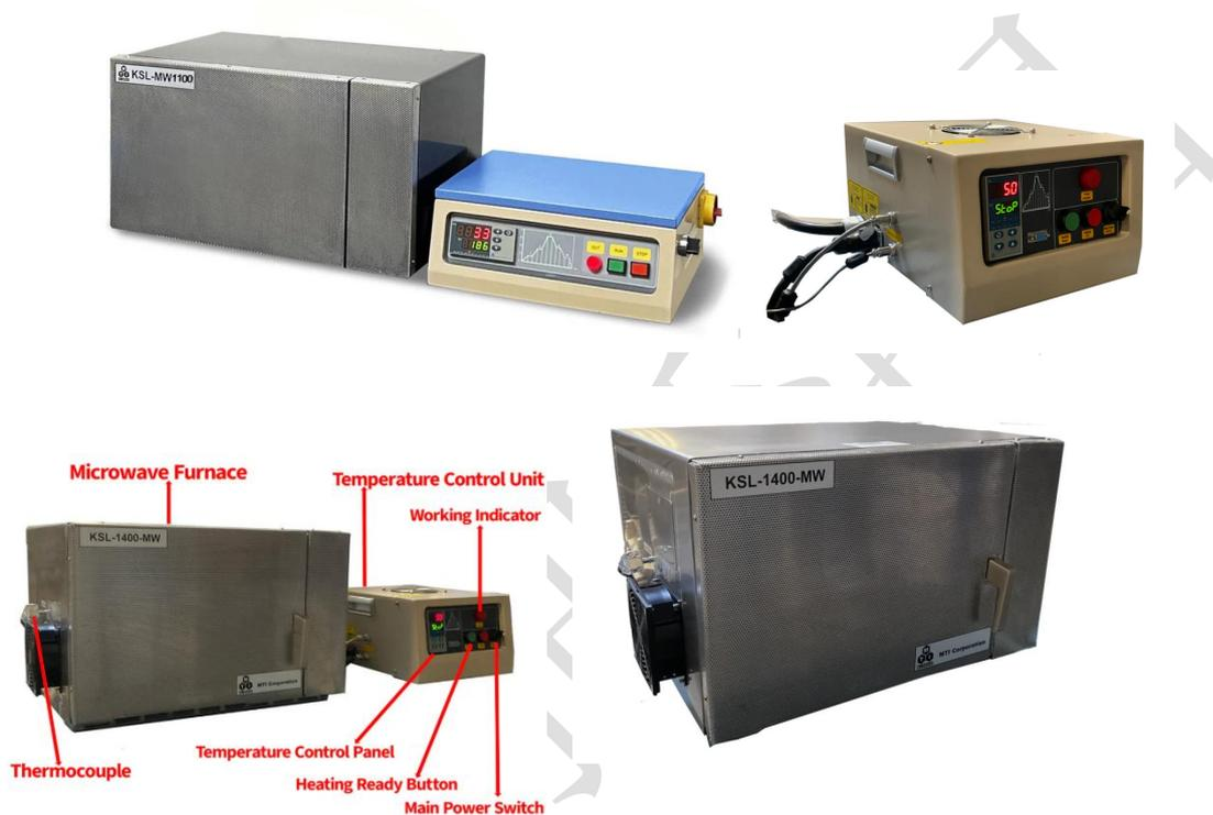
KSL-MW-XX 是一些列微波加热箱式炉，配有精确控温装置。可选购微波电源，最高加热温度可达到 1100°C 和 1400°C，加热速率可达到 100°C/分钟。此款设备特别适用于磁性材料或氧化物电子材料的烧结或热处理。
